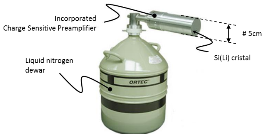
Fig. 1: a Si(Li) detector from Ortec
